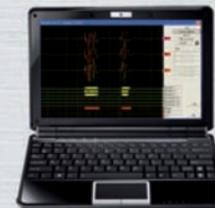
Ogni allarme rilevato dalla barriera Beamtower viene digitalizzato e memorizzato nella memoria eventi, sotto forma di tracciato grafico. Il tracciato visualizza in dettaglio il comportamento dinamico di ogni singolo raggio, il conseguente stato di allarme e l'eventuale stato di mascheramento e/o di disqualifica.
