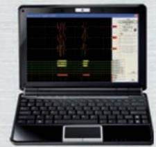
L'allineamento raggi della colonna è costantemente monitorato. Per ogni raggio che compone la barriera, sono visualizzati i dati di allineamento ed i valori di riferimento "livello allineamento", basati su una media di valori campione, ed il valore istantaneo "livello raggio".
